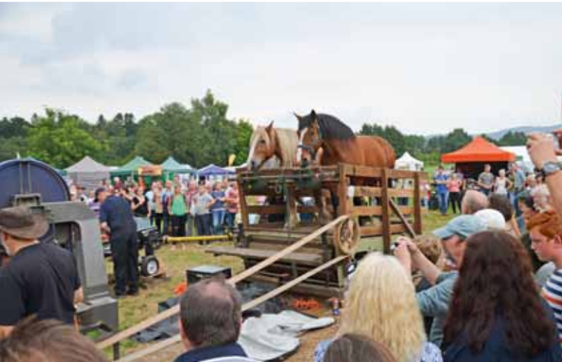
En vandring för att utvinna kraft till diverse redskap. I detta fall är det vedklyv och vedkap som drivs.
