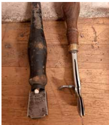
Olika typer av reffeljärn, de finns också i trä
