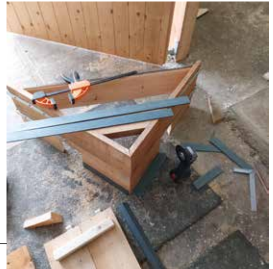
14/3: Jag har förberett och installerat "stödhjulet". Jag tog bort själva hjulet så att bara stödbenet kvarstod, och skruvade fast stödbenets klämfäste i den tvärgående plankan på plogens spets. Stödbenet tar spjårn mot en tvärgående plank mellan stöttingens medar och tar därmed "spjårn" mot stöttingen för att lyfta plogbladet. 1h
