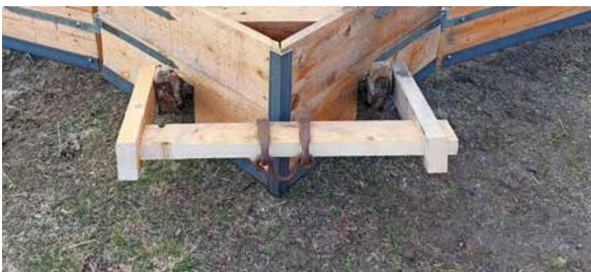
2/4: Jag monterade metallbleck på stöttingens medar. Metallblecken ska gå ner i marken när plogen körs och på så vis motverka att stöttingen sladdar eller rör sig för mycket i sidled. Jag "förlängde" även medarna och monterade ny infästning för skaklarna, detta gjordes av ett gammalt hittat beslag. 3 h
