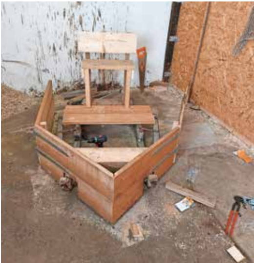
7/3: Jag har stabiliserat spetsen med metallförstärkningar då jag tror att plogen annars lätt bryts sönder vid plogning i tyngre snö. Jag har även stabiliserat sitsen med extra snedstag för att få den mer stabil och hållbar. 1h
