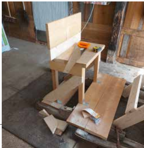
7/3: Jag har stabiliserat spetsen med metallförstärkningar då jag tror att plogen annars lätt bryts sönder vid plogning i tyngre snö. Jag har även stabiliserat sitsen med extra snedstag för att få den mer stabil och hållbar. 1h
