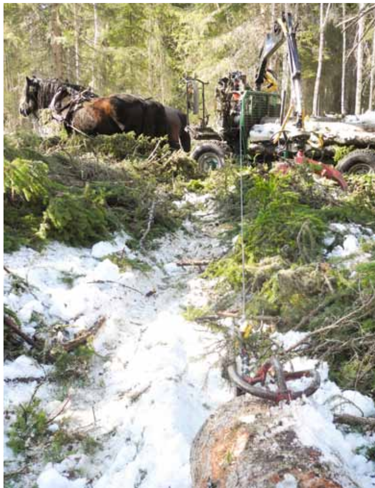
Vinschning till vagnens vänstra sida. Kranen har ställts på lämpligt sätt som extra stöd.
