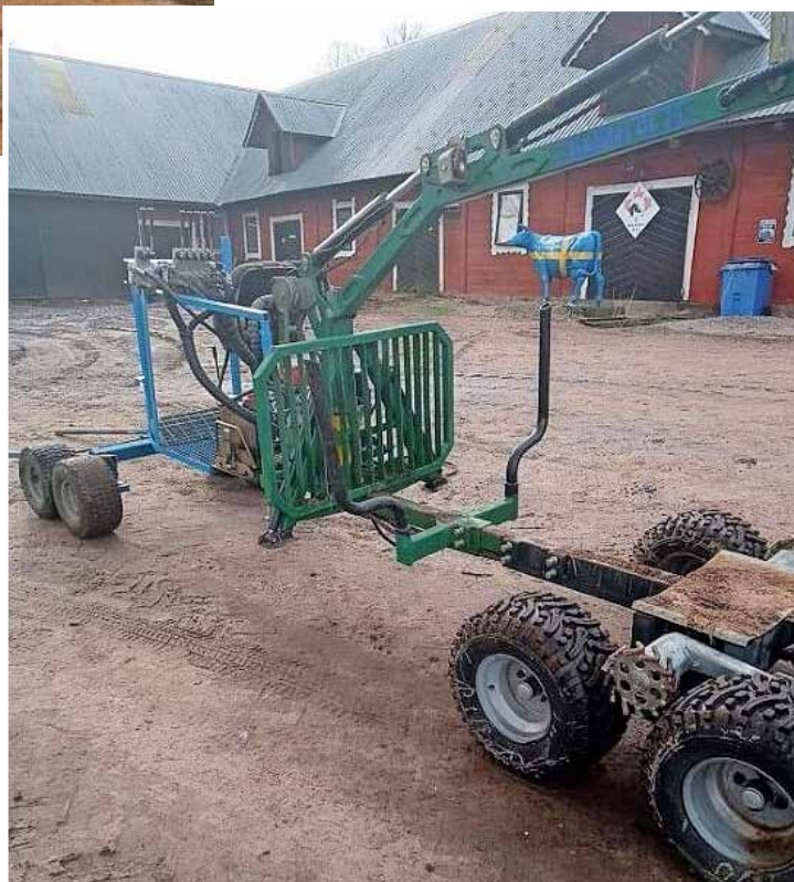
Den hydrauliska drivningen på vagnens bakaxel.
