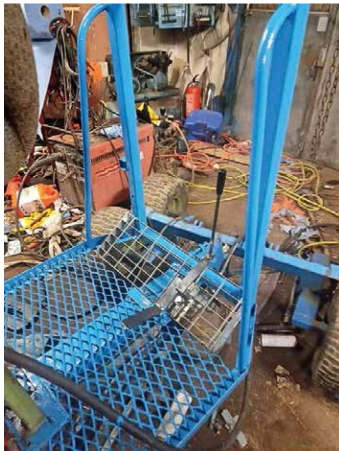
Drivningen styrs med pedalen, Spaken styr drivningen vid backning och fungerar även som broms.
