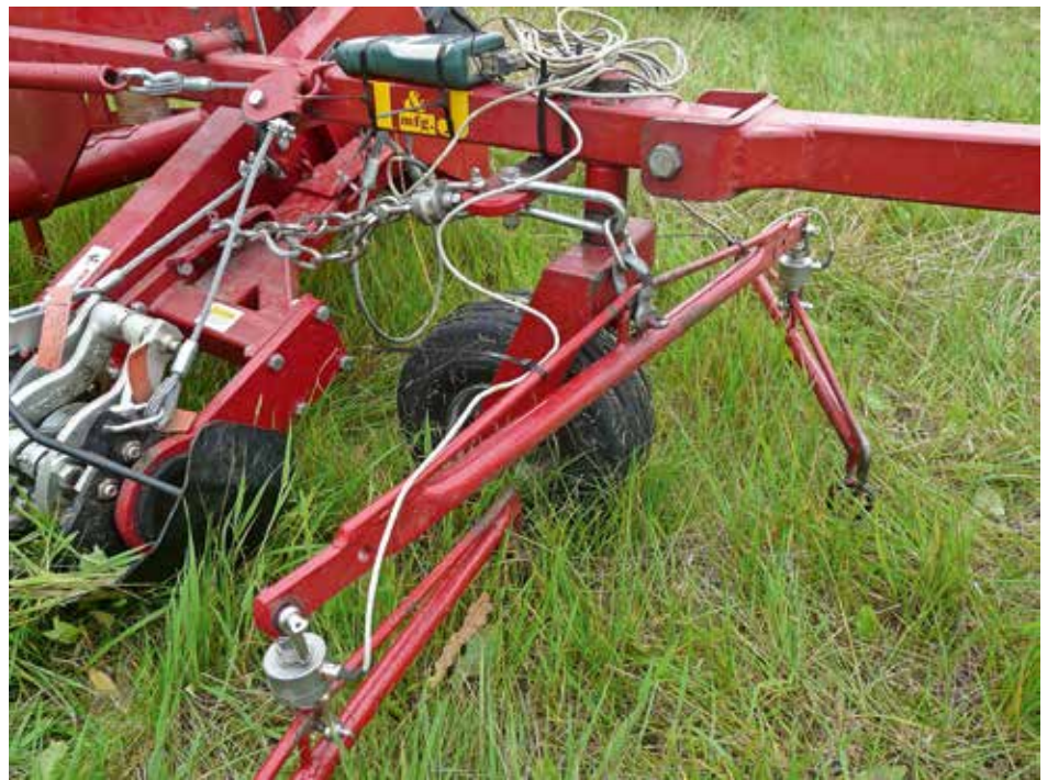
Montering av sensorerna och dataloggern på I&J-maskinen
