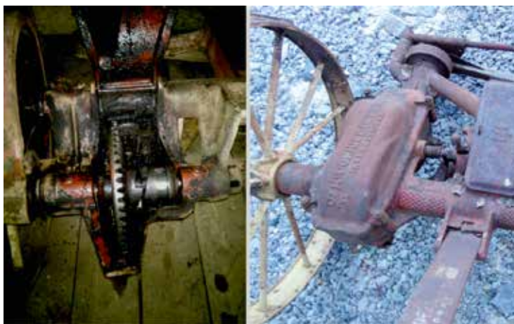
Till vänster en maskin med kopplingshus som kan öppnas och som måste smörjas. I detta behövs det en smörjning innan slåttern börjar. Till höger en maskin med stängt system och drivmekanism i oljebad.
