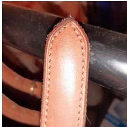
I en ände följer man kanten runt med sömmen
