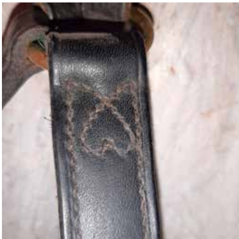
Ett sätt att avsluta sömmen på vid t.ex. en övergång mellan två läderstycken då man vill hålla ihop styckena lite extra.
