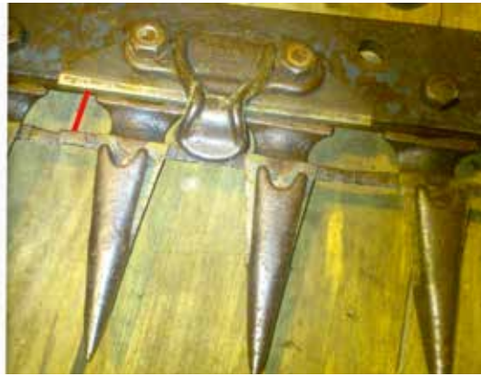
Till vänster ligger knivbladet ned på fingerstålet och gräset klipps. Till höger är det en glipa och då "tuggar" maskinen.
