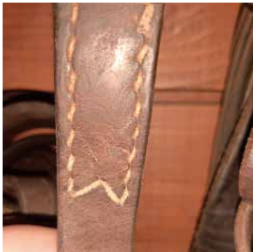
Här är en variant att avsluta sömmen på vid tex. en övergång mellan två läderstycken då man vill hålla ihop styckena lite extra
