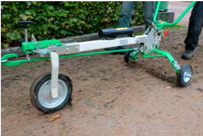
Variant av prototyp 2, med ställning och utbyttbar del med kniv.
