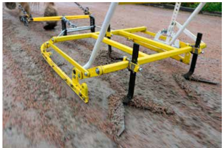
Variant av prototyp 1, med ram och utbytbar del med v-formade skär.
