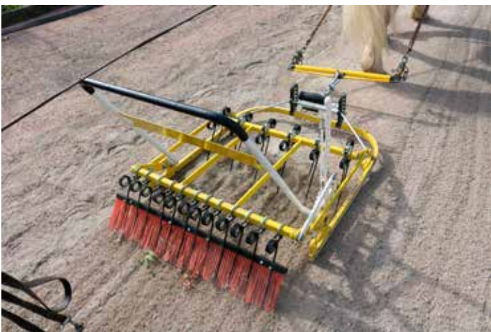
Variant av prototyp 1, med ram och utbytbar del med harvpinnar.
