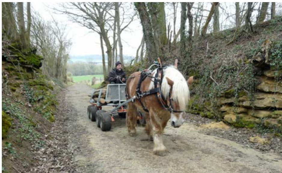
Testkörning för en frekvensanalys med kraftsensorer på båda sidor (Foto Cathy Laroche 2015)
