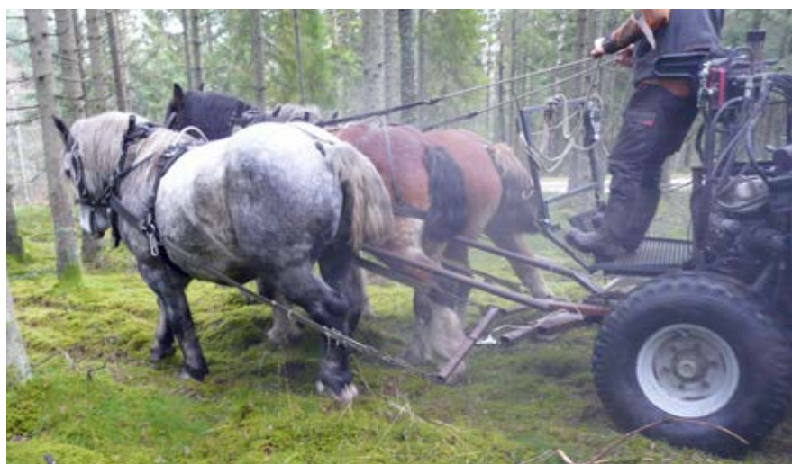
Mätutrustningen monterad med en kraftsensor på varje svängel och dataloggern fäst på kuskplattformen (Foto Paul Schmit 2021)
